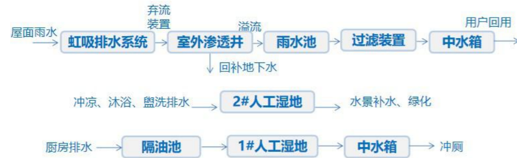
图 4.3-3 生态处理设施流程图
