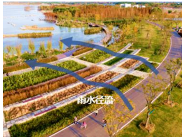
图 5.2-33 梯级海绵净化系统
