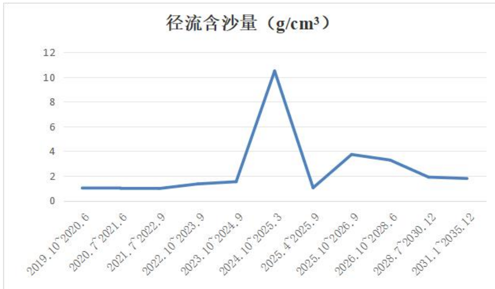
图 4-1 施工期项目区内径流含沙量变化折线图
