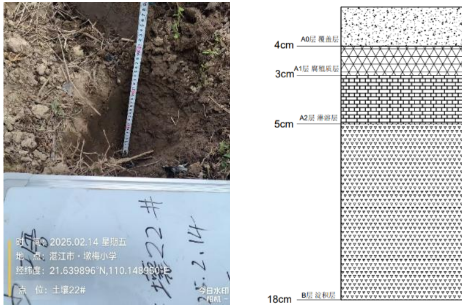
图 2-11 22 号采样点表土层剖面图
