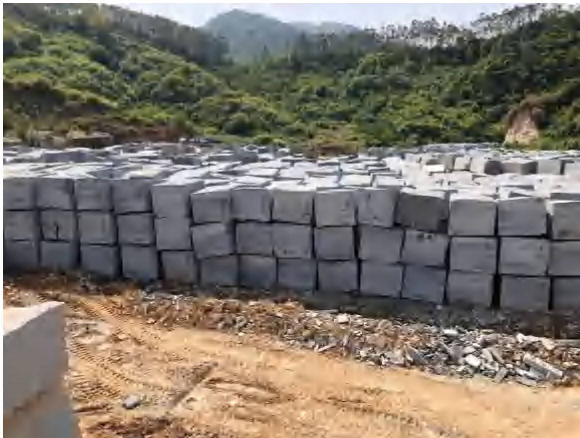
图 1-4 某矿山饰面用花岗岩荒料堆场
