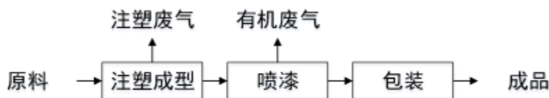
图3.2-10 塑料制件制造生产工艺流程图
