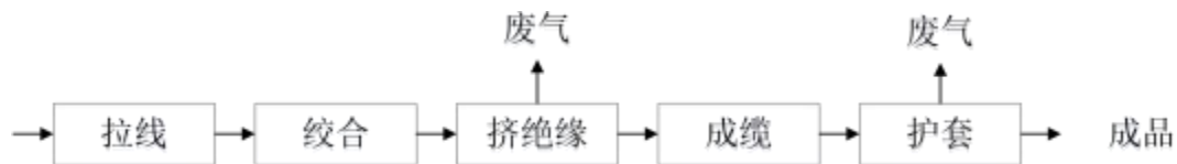
图3.2-7 电缆生产工艺流程图
