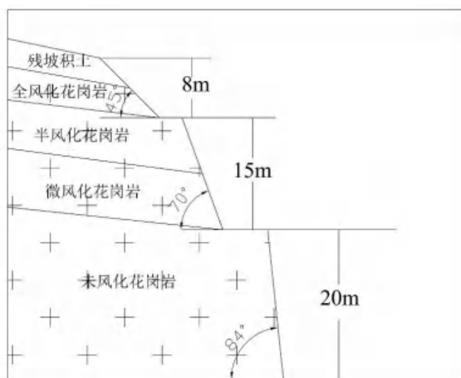
图 3-1 露天采场典型土质边坡（单台阶）剖面示意图
