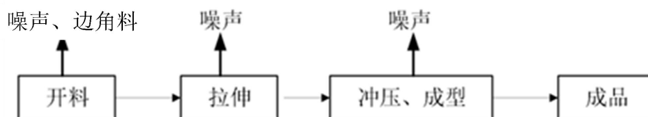
图2-4 电饭锅钢盖生产工艺流程图
