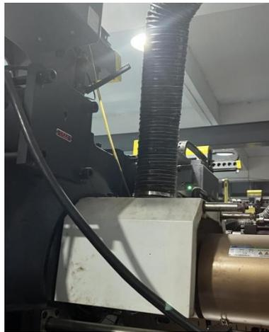
图4-1 包围型集气罩位置照片（图样）
