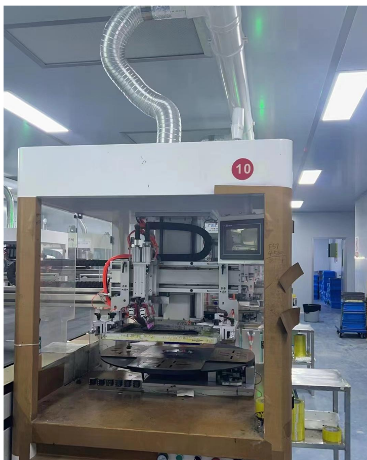
图 4-2 负压洁净车间收集示意图&丝印机收集示意图
