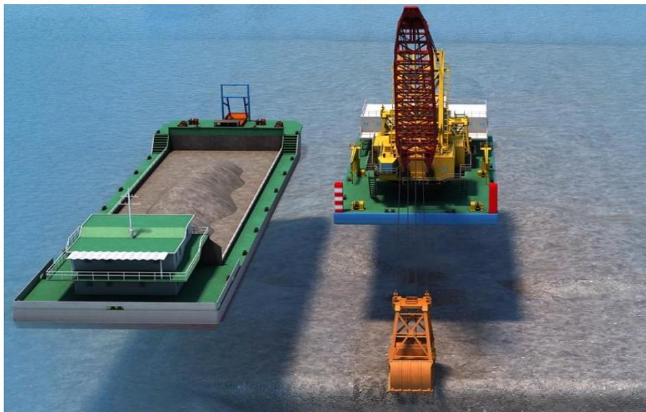
图 2.3.2-7 抓斗船挖泥布置示意图
