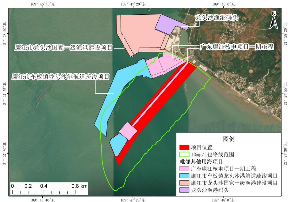
图 5.1.3-2 项目用海周边海域权属与 10mg/L 悬浮泥沙包络线叠加分析图
