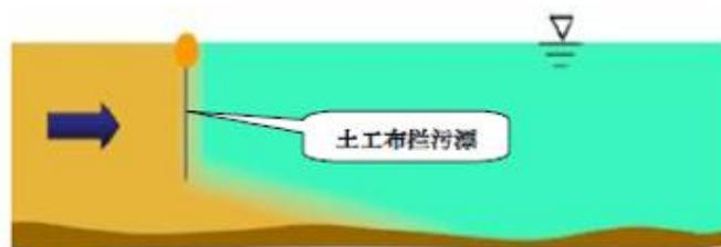
图 8.2.3-2 有土工布拦污屏泥浆扩散图
