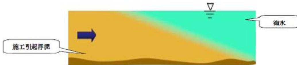
图 8.2.3-1 无土工布拦污屏泥浆扩散图
