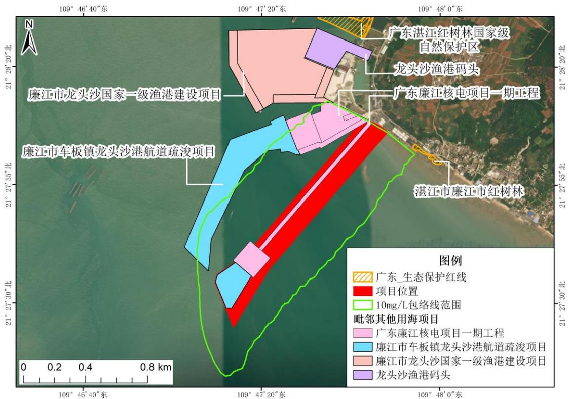
图 5.1.2-2a 项目用海周边开发利用与 10mg/L 悬浮泥沙包络线叠加分析图
