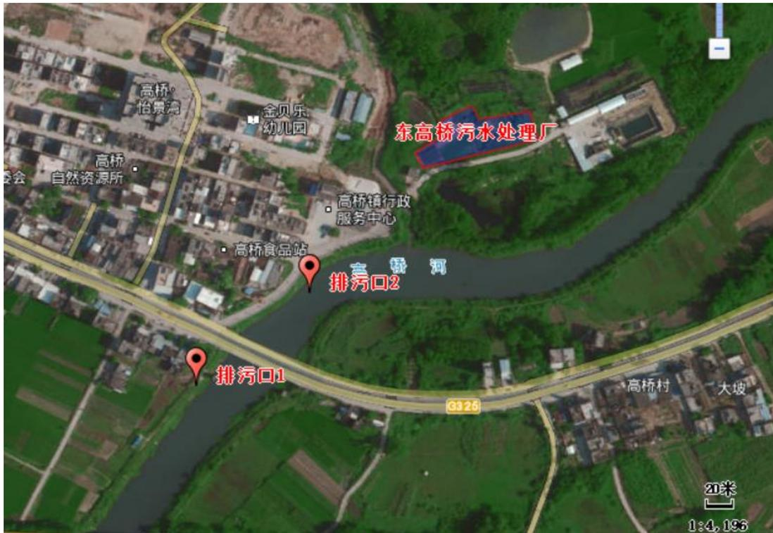
图 3.1 水质净化厂附近排污口分布情况图
